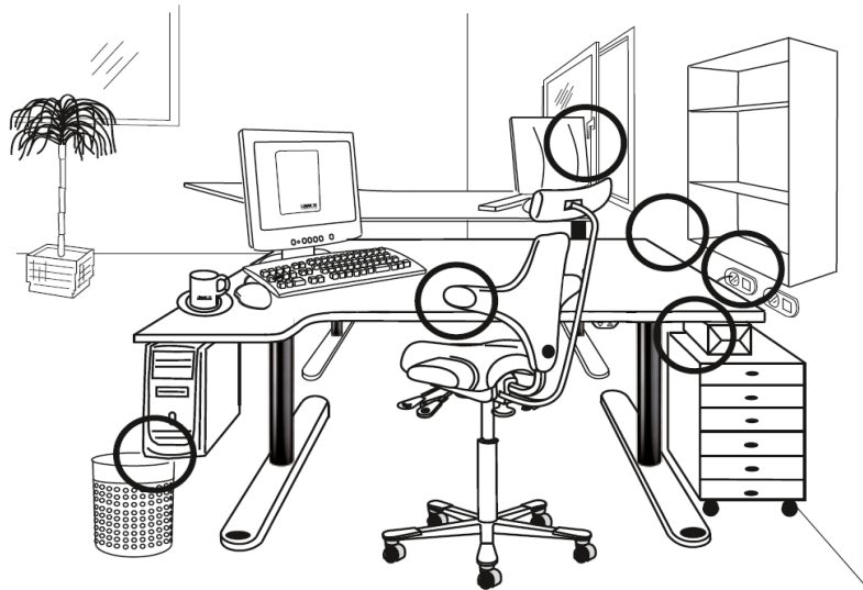
Beispiele, in denen der Sicherheitssensor ein Einklemmen verhindern kann
